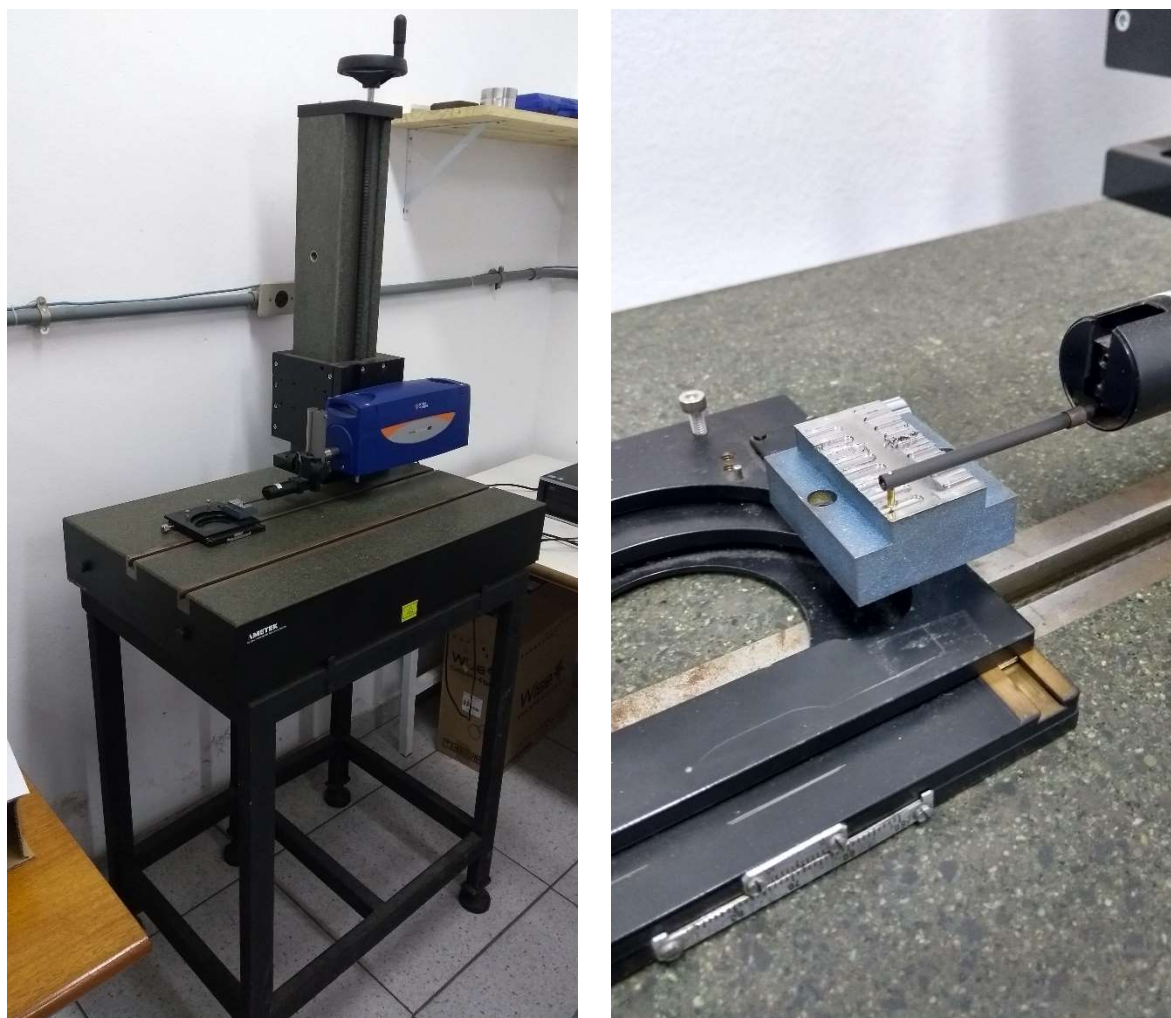
Figura 4.7: Perfilômetro Taylor Hobson (a) e seu apalpador realizando a medição de rugosidade na peça (b).
